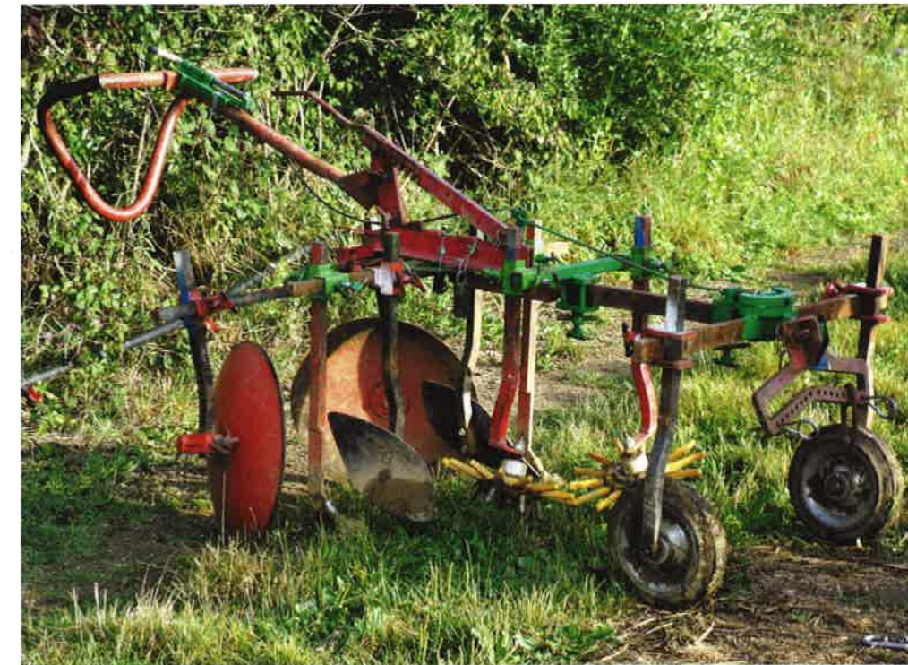
◆ La Kassine équipée des dernières innovations : avant-train directionnel pour plus de maniabilité dans les virages serrés; les doigts bineurs (étoile jaune) pour desherber sur le rang et autres socs pour les desherbages, permettent de nettoyer l'ensemble de la butte en un passage au lieu de quatre.
